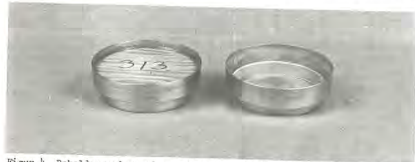
Figur 4. Beholder med og uden prøvelegeme til bestemmelse af dampdiffusionsmodstandstallet. Beholderen har en diameter på 175 mm.
